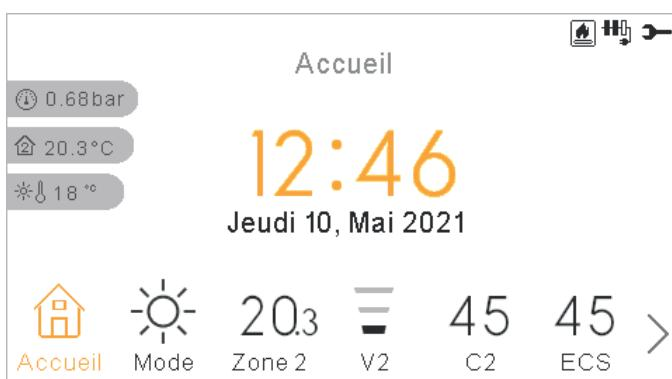
La vue principale de l'appareil est composée d'un widget d'onglet inférieur permettant de se déplacer dans les différentes vues :
