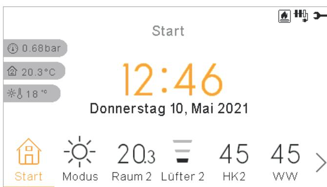
Die Hauptansicht des Geräts besteht aus einem unteren Registerkarten-Widget, mit dem Sie zwischen den verschiedenen Ansichten wechseln können:
